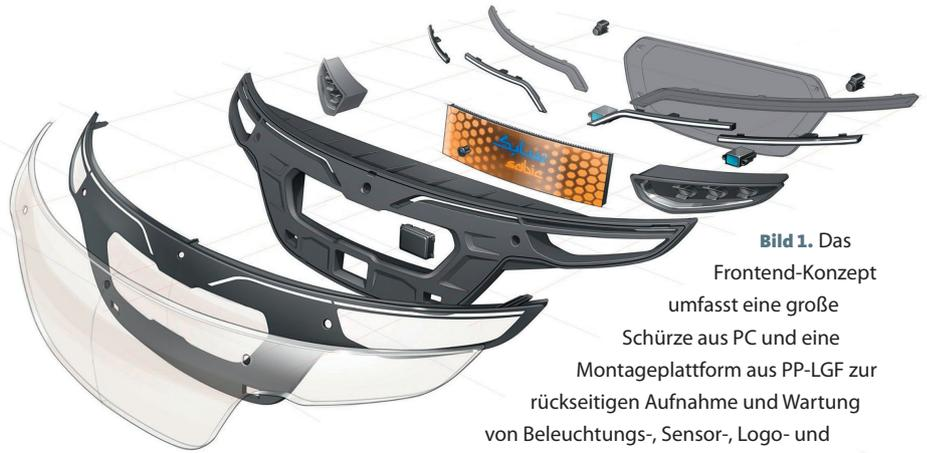
**Bild 1.** Das Frontend-Konzept umfasst eine große Schürze aus PC und eine Montageplattform aus PP-LGF zur rückseitigen Aufnahme und Wartung von Beleuchtungs-, Sensor-, Logo- und Messaging-Einheiten. © Sabic
