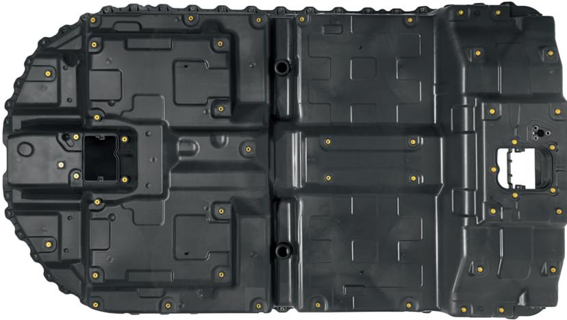
**Bild 5.** Die erste thermoplastische EV-Batteriepack-Abdeckung im Einklang mit strengen internationalen Brandschutzanforderungen sorgt für eine Gewichtseinsparung von 40 % gegenüber vergleichbaren Stahlkonstruktionen. Das halogenfrei flammwidrige, verzugsarme PP-Compound von Sabic macht die ansonsten notwendige Wärmeabschirmung unnötig. © Sabic
