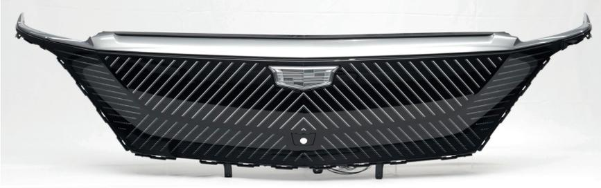
**Bild 2.** Das markante Frontpanel für den Cadillac Lyriq wird mittels Laserabtrag hergestellt. Zur Begrüßung des Fahrers sind hinterleuchtete Designelemente integriert. © General Motors, Sabc
