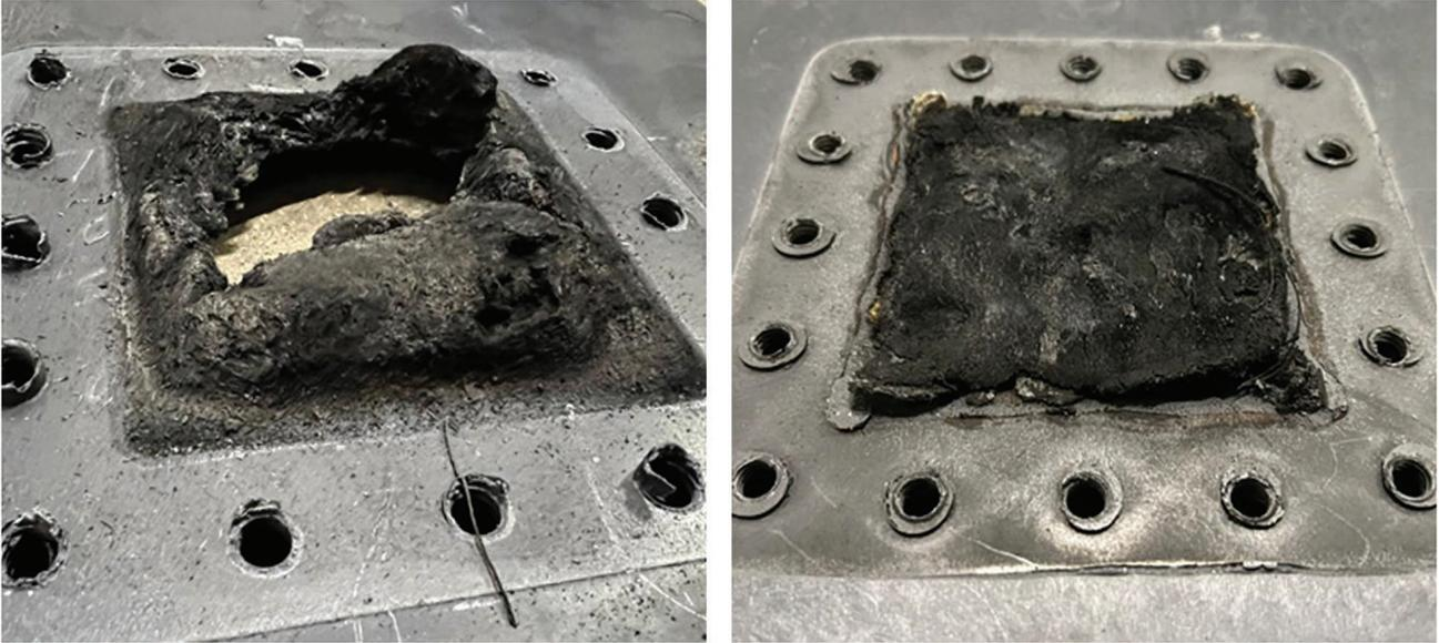
**Bild 6.** Test nach dem UL-Standard 2596, der ein thermisches Durchgehen von Batterien simuliert: Die Batteriezellen mit Wärmebarrieren aus Stamax-PP-LGF (rechts) verhindern im Gegensatz zu einem Standardmaterial (links) einen Durchbruch der Platte. © Sabic, Underwriters Laboratories
